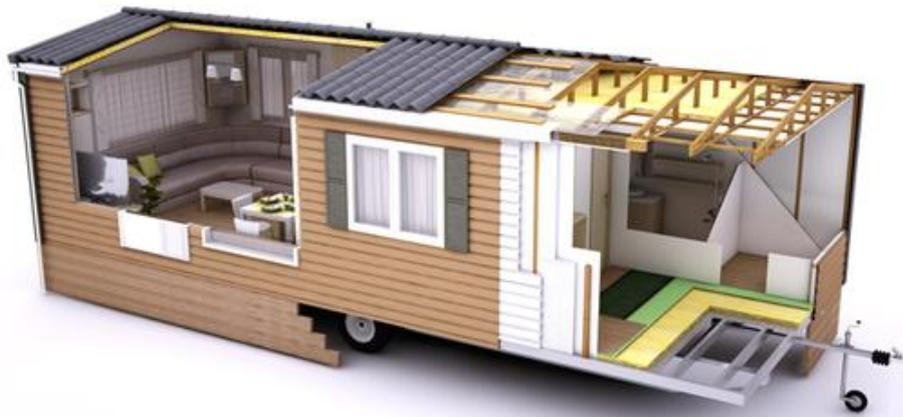
Un mobilhome se compose d'un châssis métallique sur roues avec un timon ainsi qu'une construction (structure) dont la hauteur ne peut excéder 4 m depuis le „terrain naturel“.
